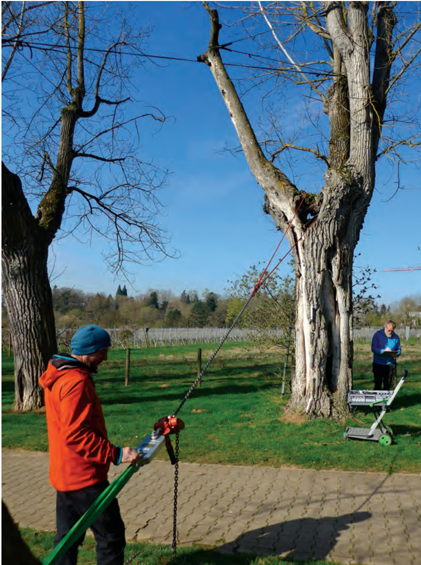
Prova di trazione per il calcolo nel legno residuale
